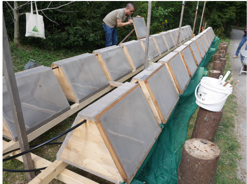
Versuch: Wirkung von Beregnung auf den Schlupf des Buchdruckers
